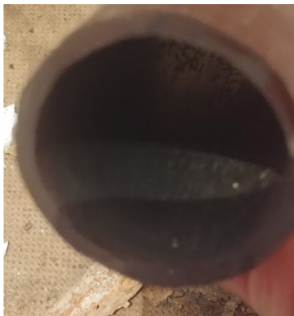
Рисунок 4 – Образец, охлажденный водо-воздушной смесью, после снятия окалины
