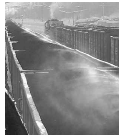
Рисунок 1 – Уголь, транспортируемый в полувагонах, начинает смерзаться превращаясь в цельный агрегат
