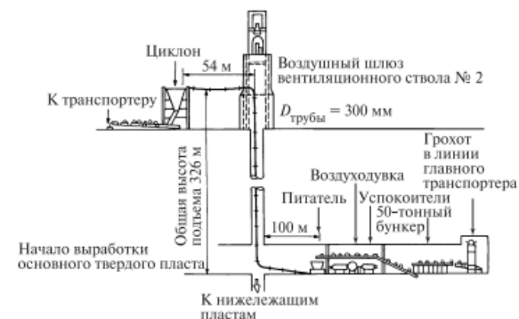
Рисунок 1 – Принципиальная схема системы пневмотранспорта угля шахты Шайрбрук
