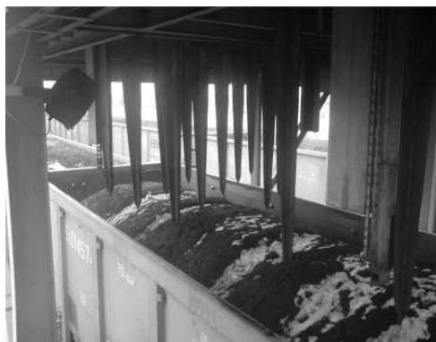
Рисунок 3 – Вид на рыхлящие штыри перед внедрением в смерзшийся угольный агрегат
