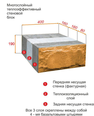
Рисунок 1 – Конструкция наружной стены
