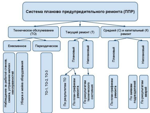
Рисунок 1 – Пример системы Планово-предупредительного ремонта
