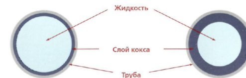
Рисунок 2 – Закоксовывание поперечного сечения трубчатого змеевика
